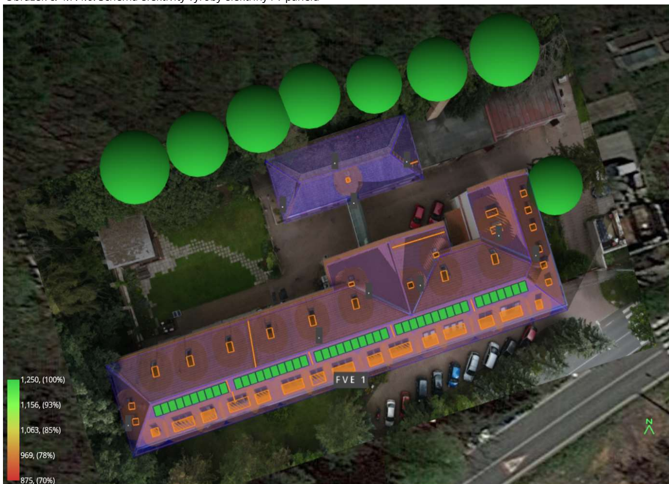
Obrázek č. 4.7.4.6: Schéma efektivity výroby elektřiny FV panelů
